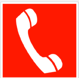
Знак F05 «Телефон для использования при пожаре» ГОСТ 12.4.026
