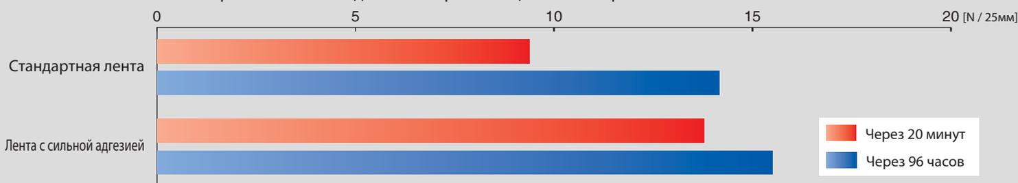
Измерения через 96 часов после нанесения (метод испытания соответствует JIS Z 0237, однако продолжительность нанесения составляет 96 часов)
