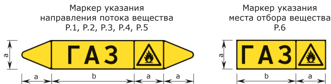
Рисунок 1 - Размеры самоклеющихся маркеров
